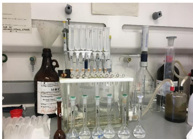
Figura 8. Preparazione dei campioni per costruire la curva di calibrazione.
