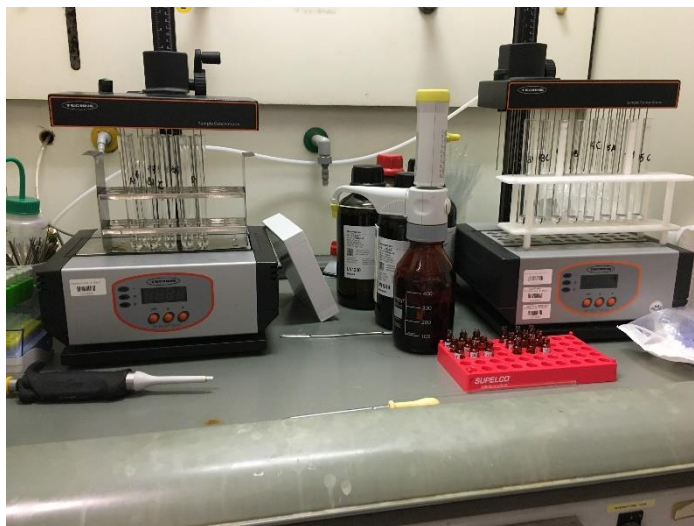
Figura 7. Fase di concentrazione dell'estratto prima di essere analizzato in GC_MS_MS per la determinazione della concentrazione di rotundone.
