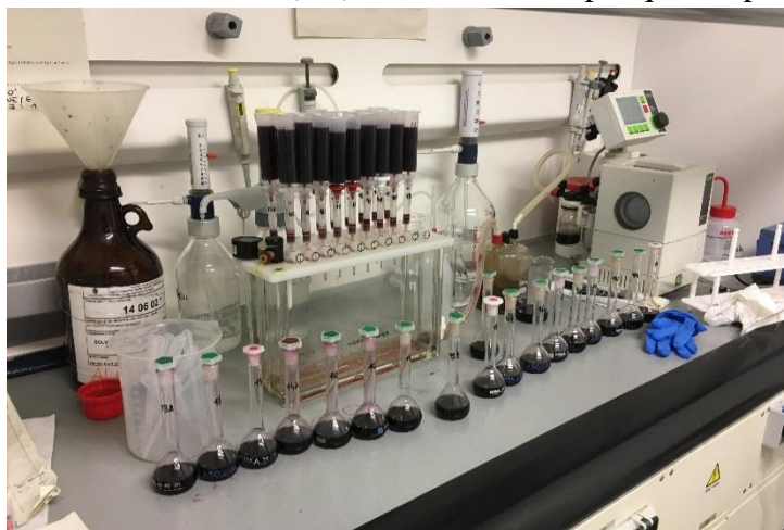
Figura 6. Fase di estrazione del Rotundone attraverso filtrazione su resine.
