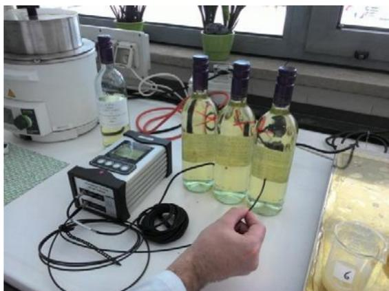
Ogni dispositivo è dotato di una sonda di temperatura e di un barometro per correggere i dati prendendo in considerazione le influenze derivanti da temperatura e pressione. Oltre alla misura dell'ossigeno disciolto è possibile misurare anche la concentrazione dell'ossigeno nello spazio di testa applicando un sensore nella parte alta della bottiglia e inserendo il dato del volume dello spazio della bottiglia occupato dall'aria<sup>18</sup>.
