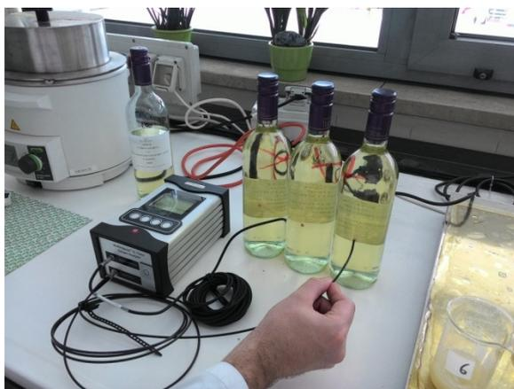
Figura 17 Particolare durante la misura dell'ossigeno disciolto con sonda NomaSense
