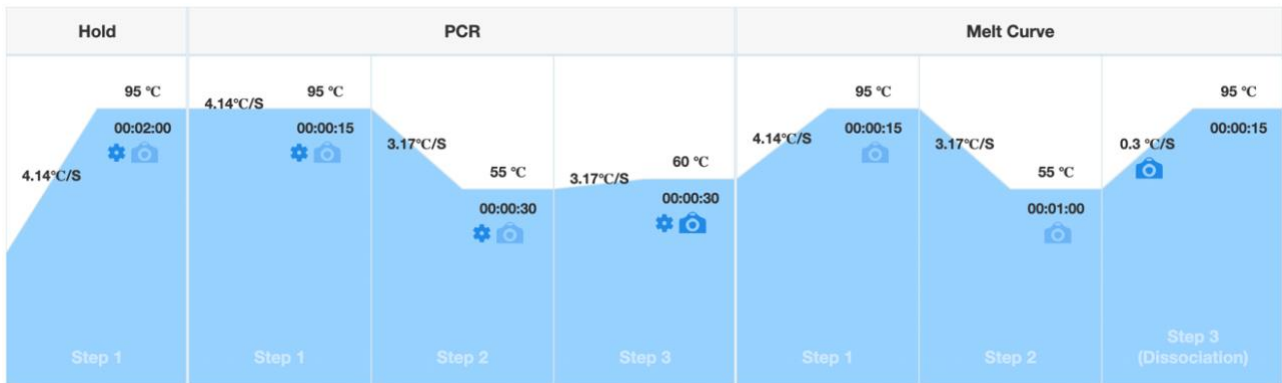
Figura 7: Temperatura e cicli della q-PCR, ottenuti tramite l'utilizzo dello strumento Applied biosystem qPCR della marca Thermo Fisher.
